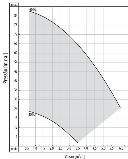
Modelo: VFD VME-3620 - 30/60 Hz - II polos
